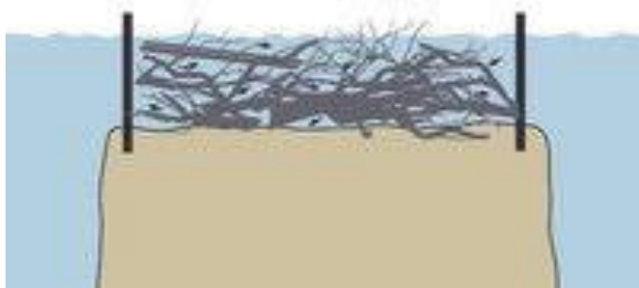
Figuur 31 Voorbeeld uit Vinkeveense plassen waar door middel van sonar de deels weggeslagen legakkers zijn opgespoord en vervolgens zijn aangevuld tot waterniveau met takkenbossen.
